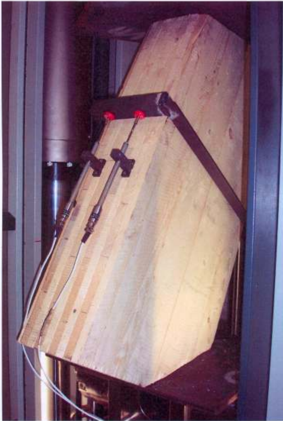
Abbildung 2: Eingebauter Prüfkörper im Prüfstand „Zwick“ inkl. Messwertaufnehmer.
