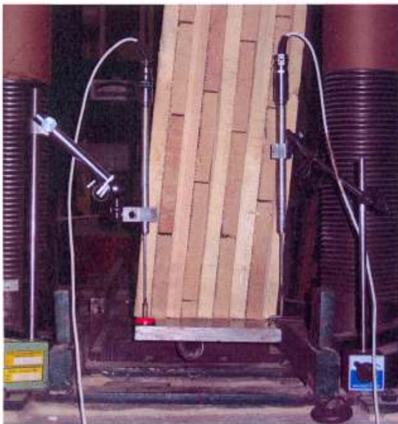
Abbildung 9: Verformung des Prüfkörpers MHM-Druck 4 am Auflager (Relativ-Verschiebung der Brettlagen)
