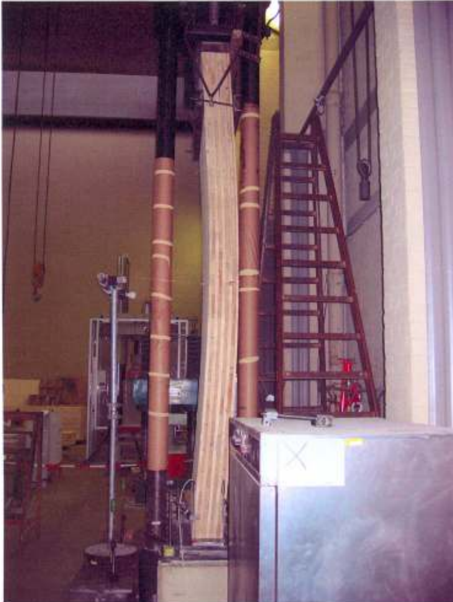
Abbildung 6: Ausbiegung beim Druckversuch MHM-Druck 4
