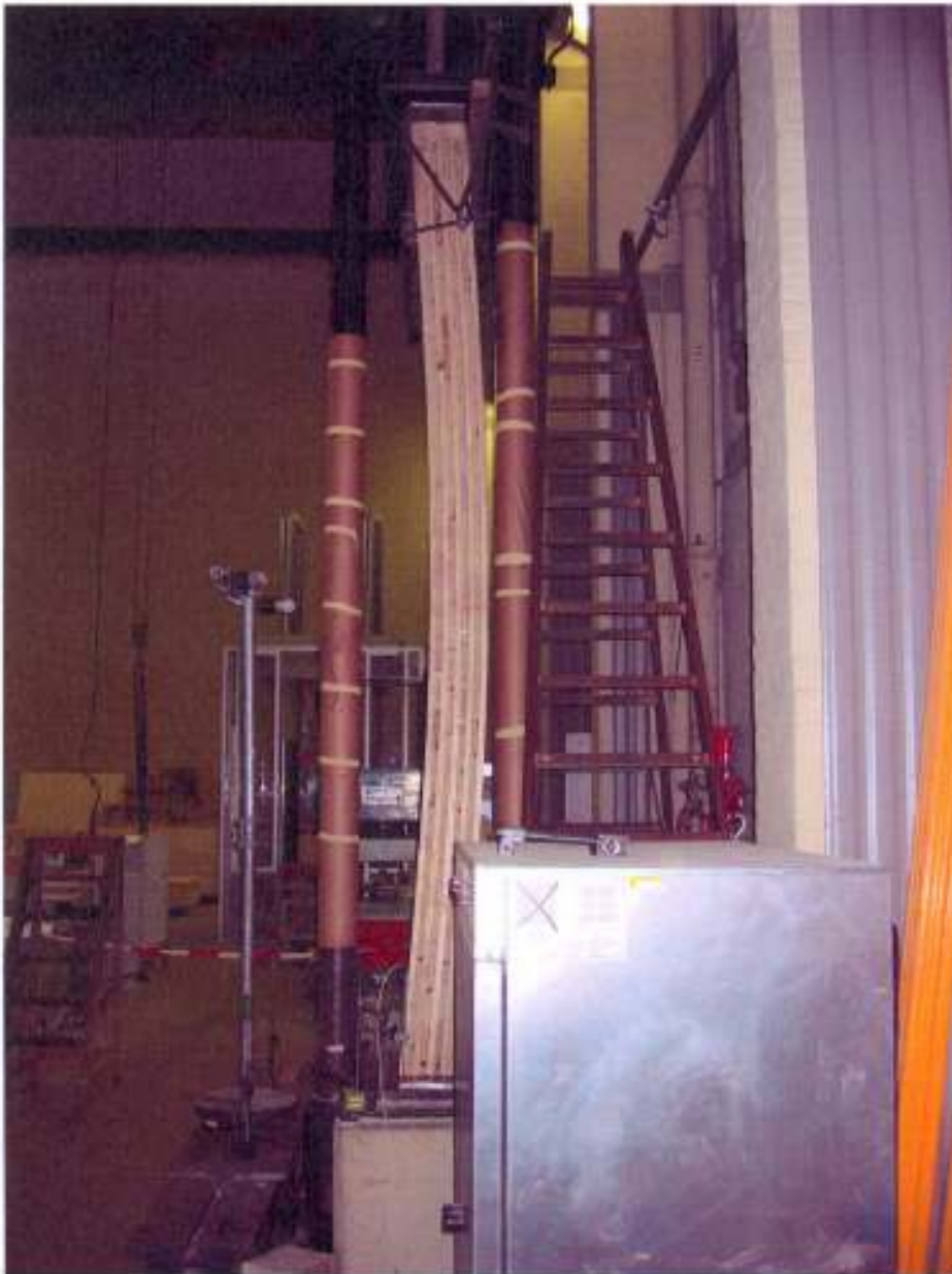
Abbildung 5: Ausbiegung beim Druckversuch MHM-Druck 1
