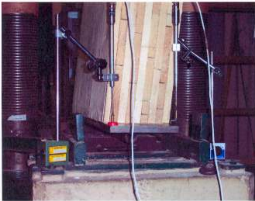
Abbildung 8: Verformung des Prüfkörpers MHM-Druck 4 am Auflager (Relativ-Verschiebung der Brettlagen)
