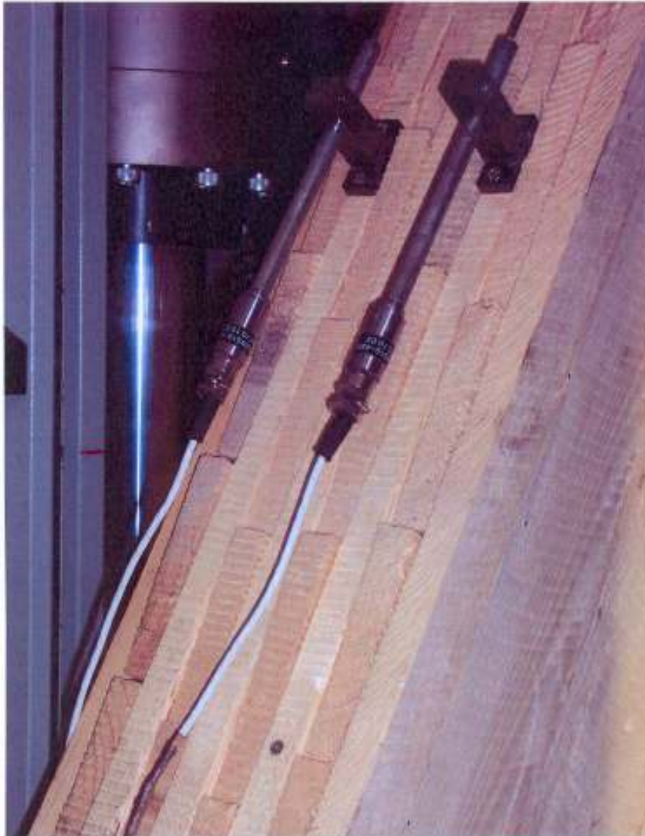
Abbildung 4: Verdrehung der Querlagen zu den Längslagen
