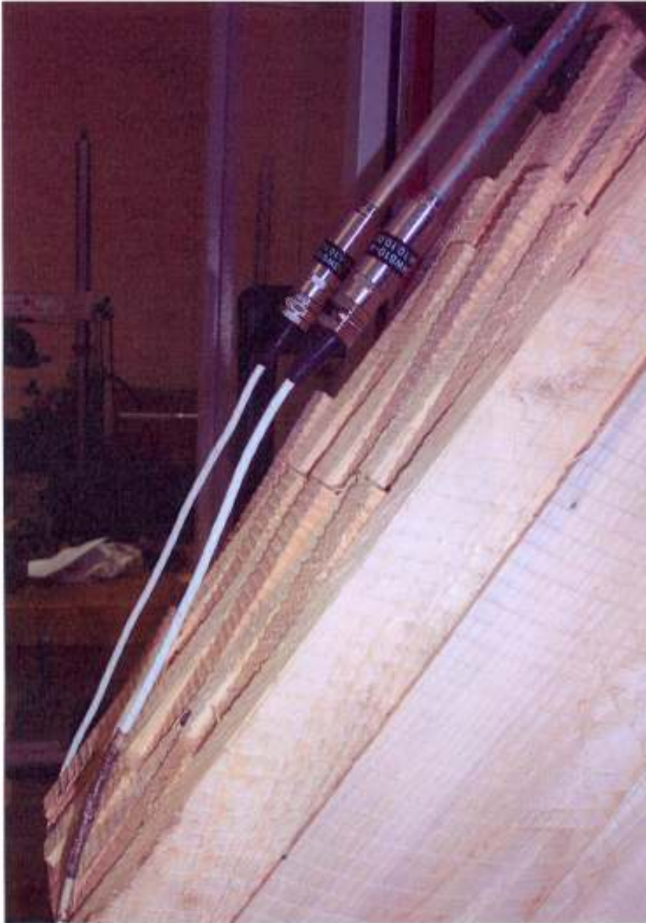
Abbildung 3: Verdrehung der Querlagen zu den Längslagen beim Schub-Prüfkörper
