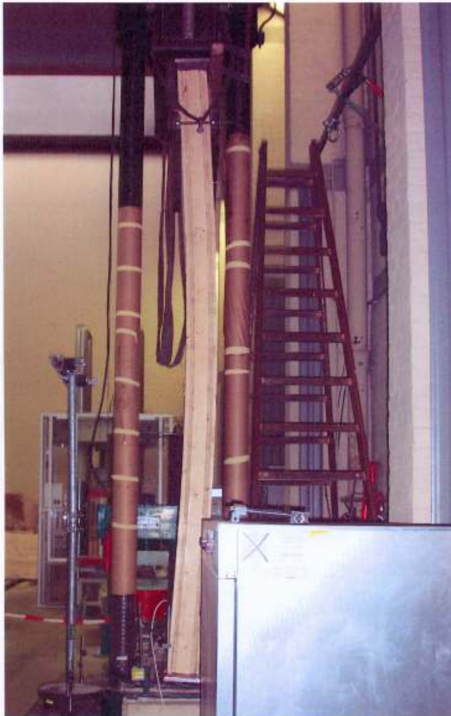
Abbildung 7: Ausbiegung beim Druckversuch MHM-Druck 8
